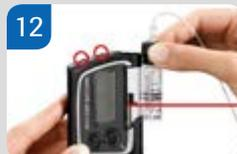
12 Нажимайте ▲ или ▼ чтобы передвинуть поршневый стержень таким образом, чтобы концевая пластина стержня находилась на одном уровне с нижней частью поршня картриджа.
