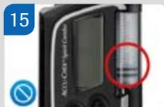
Картридж правильно вставлен в отсек, если концевая пластина поршневого стержня прилегает к поршню картриджа.
