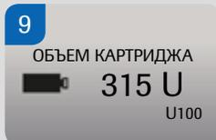
9 Когда поршневый стержень будет полностью убран, на дисплее отобразится экран ОБЪЕМ КАРТРИДЖА с указанием максимально допустимого объема – 315 U.
