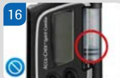
Если концевая пластина стержня не выровнена с поршнем картриджа, выньте картридж из отсека и повторите шаги 10–14.
